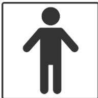
Partes Aplicadas: Tipo BF (CEI-EN 60601-1: 2007). Dispositivo do tipo B (dispositivo com proteção específica contra riscos elétricos, em particular no que diz respeito a correntes de dispersão admissíveis) com partes aplicadas do tipo F (flutuante: a parte aplicada é isolada de todas as outras partes do aparelho de modo que a corrente de dispersão no paciente em condição de falha não seja ultrapassada).
